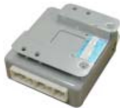
STICS 在车速为 3Km/h或以上时，接发安全气囊展开信号后 40ms，它发送车门开锁信号 5秒钟。
