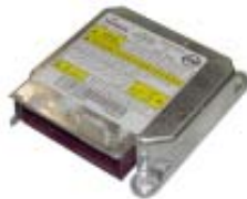
安全气囊总成 (SDM) 碰撞 G-传感器安装在它的内部。它发送信号，展开前安全气囊（驾驶席和助手席安全气囊）和驾驶席和助手席安全带拉紧器。当前碰撞G-传感器金发送安全气囊展开信号时，此信号展开两个前安全气囊并使它们的安全带拉紧器工作。
